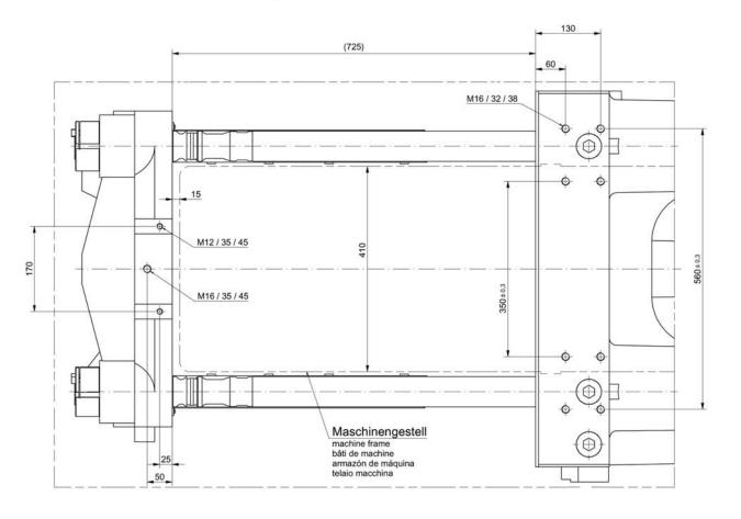
Befestigungsbohrungen für Handlinggerät
